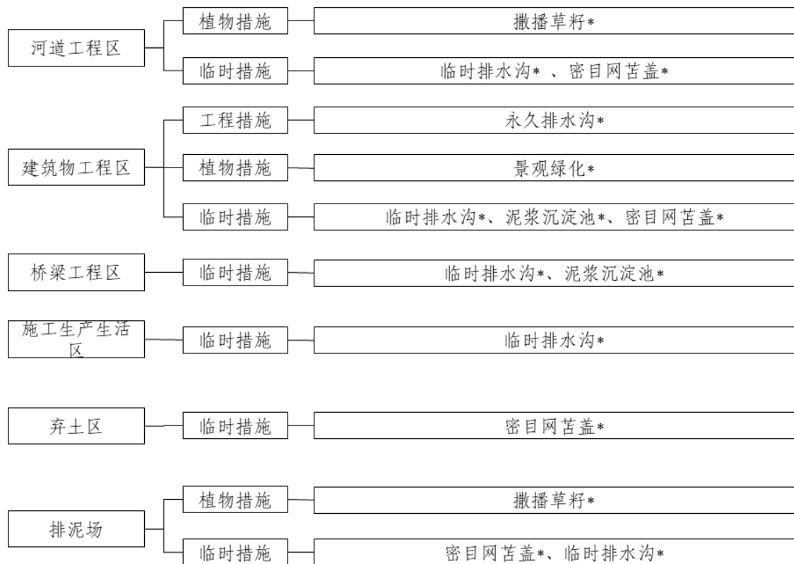
图 1-1 水土流失防治措施总体布局图
